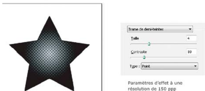
Effet de trame de demi-teintes avant et après modification de la résolution de 300 ppp à 150 ppp
